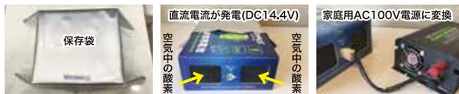
電池を保存袋から取り出し、空気中の酸素を取り込む事で発電します。接続ケーブルで付属インバータと電池をつなぐだけで準備は完了です。インバータの電源をONにすると、100V家電製品に電気を供給します。インバータのUSB端子はインバータ電源OFFのままでスマホ等に充電できます。
